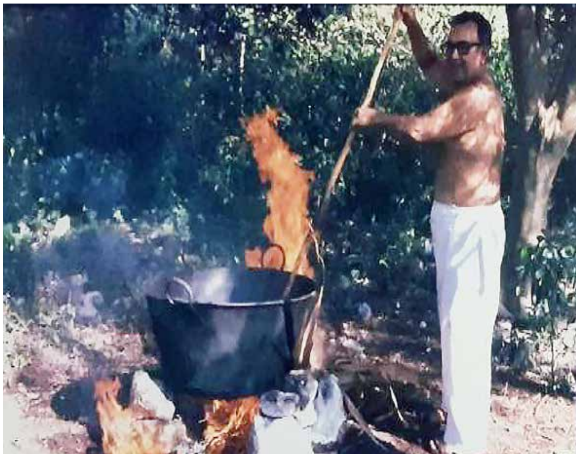
Ese es don Mech Álvarez cocinando chicle, para luego tirarlo sobre unas lonas con jabón, y en unos cuadros que llevaban más o menos 10 kilos, ir haciendo las marquetas de chicle.
